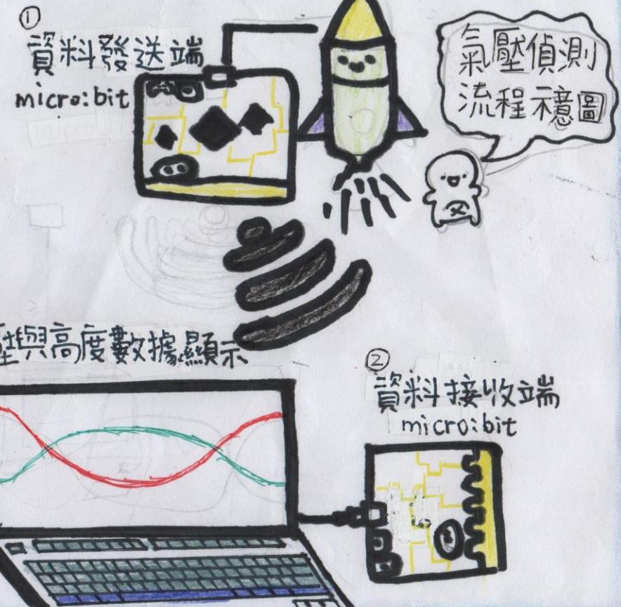
用 micro:bit 插上擴展版後，將 BME280 感測器連上接腳，設計感測大氣壓力的程式，事後再轉成高度。
