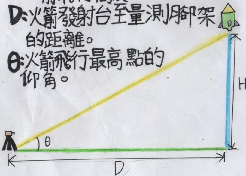
用角度尺測量出水火箭的仰角，並根據發射點到角度尺距離，利用三角函數，推算出高度。
