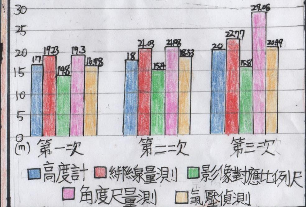
我們共進行三次實驗。將三次結果統整後，與對照組的誤差由大到小排列：角度尺 > 比例尺 > 純線 > 氣壓。綜合以上，氣壓偵測是最好的方法，誤差小（平均 +0.26m）且容易操作。
