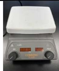
圖 7 加熱攪拌器
