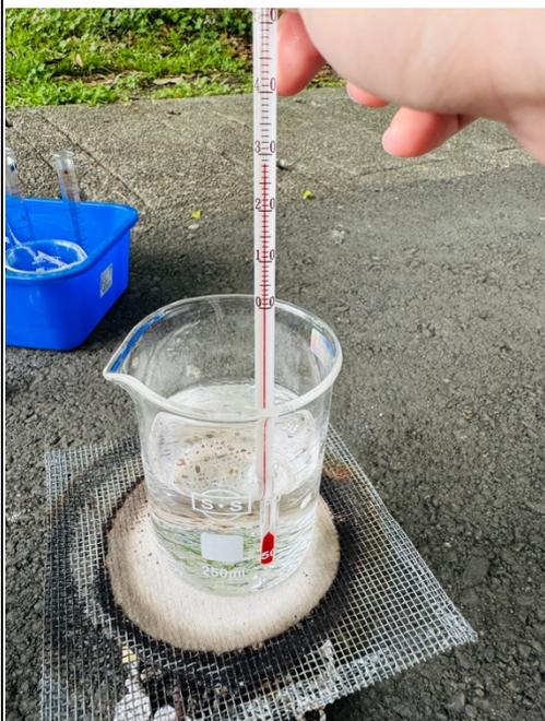
從實驗結果可以得知，二次燃燒爐只有在一開始跟快燒完的情況下會有一點煙，其燃燒過程中可以達到無煙的效果，但不適合在上方放密封型的架子，容易造成進氧量不足，而孔洞距離越密集，火焰越集中燃燒效果最好，每秒鐘可提供的熱量最多，為 20.33cal，在野外燃燒材料有限，我們能提升燃燒的效能，加快煮東西的速度，但缺點為無法控制火的大小。此外，我們想到，在台灣的宗教信仰中，燒金紙是非常普遍的現象，因此用在金爐桶的改造，也是非常棒的應用，可以減少廢煙的排放，減少燃燒不完全的情形，希望可以透過此方法來減少空氣污染，為環境保護盡一份心力。
