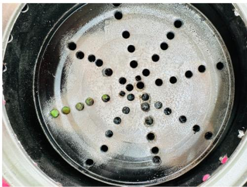
3. 將小奶粉罐上方打上不同密集度的孔，先用釘子打洞，再用電鑽擴孔，其孔徑大小皆為 0.5cm，此為二次進氣的進氣孔。
