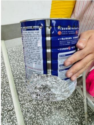
2. 將小奶粉罐底部打出第一次燃燒的進氣孔，先用釘子打洞，再用電鑽擴孔，其孔洞大小皆為 0.5cm、數量與排列方式皆一致。
