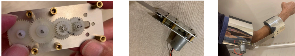
圖7, 手臂彎曲運動能量收集器的製作
