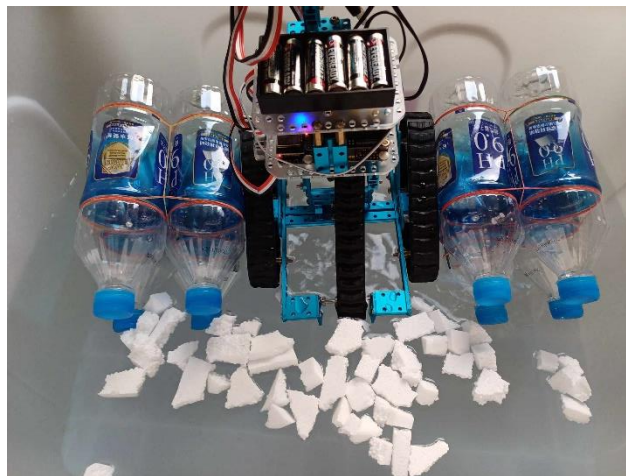
圖（三）將機體放置於水箱中，進行情境模擬。
