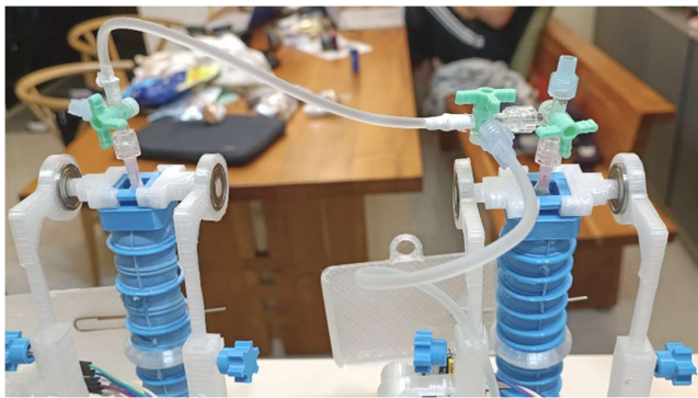
連通管連接頂部端點，不會干擾模型彎折運動，也能確保兩個模型內注水壓力
