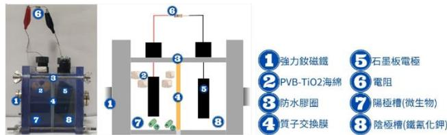
圖三、微生物燃料電池側視實體+示意圖(作者自行繪製)
