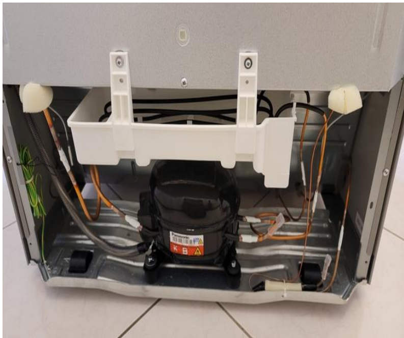
(冰箱的壓縮機，白色的盒子是蒸發盤)
