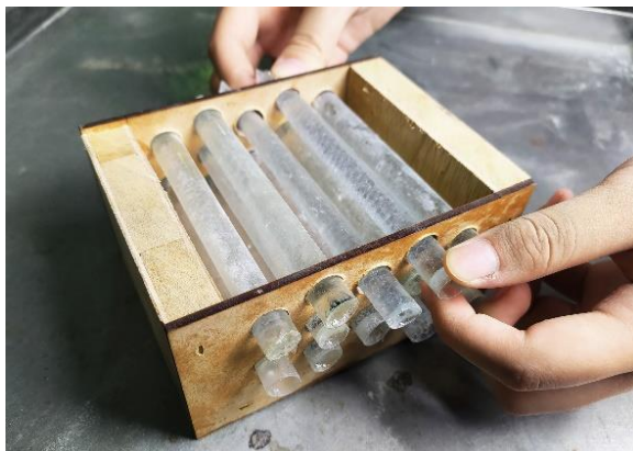
圖 8：將玻璃管插入木模中
