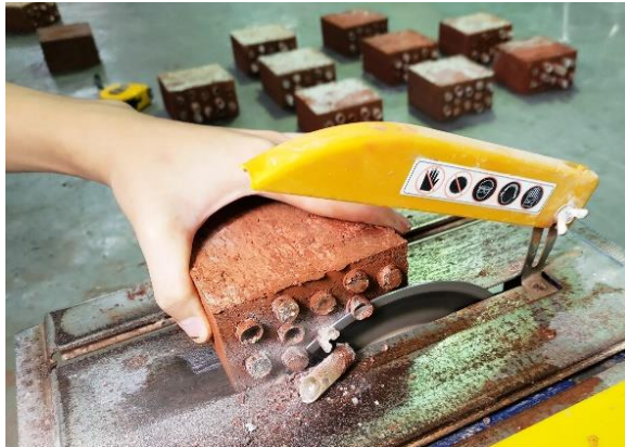
圖 10：切除兩側多餘的玻璃管
