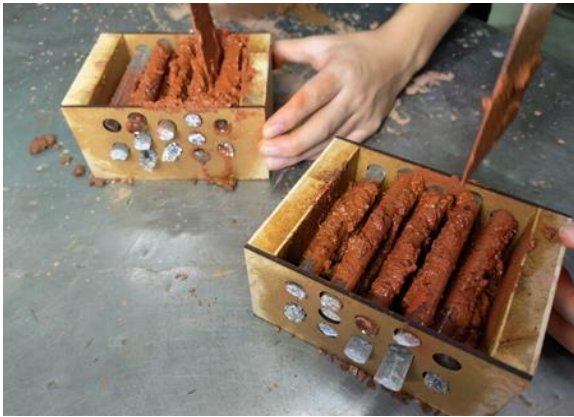
圖 15：使用廢棄玻璃可製作透光環保磚
