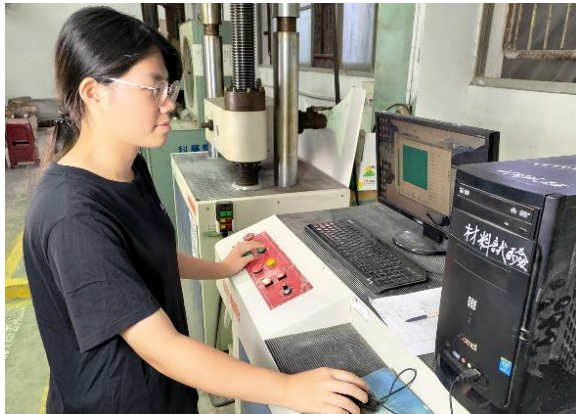
圖 13：調整抗壓強度試驗之加速度
